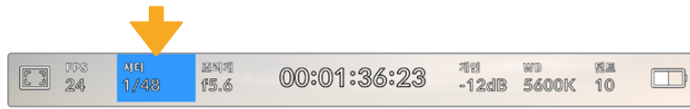
URSA Broadcast G2의 셔터 상태 정보. 이 상태 정보를 누르면 셔터 설정이 나타납니다.
