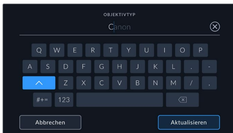
Geben Sie Objektivdaten mithilfe der Touchtastatur ein, sollten diese nicht automatisch erscheinen
