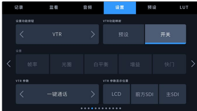
将B4镜头上“VTR”按钮配置为“一键通话”按钮
