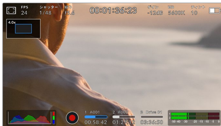
ズームインしている際、LCDタッチスクリーン左上のインジケーターは、見ているイメージの領域を表示。メニューホイール (MENU) を使用するか、画面で指をドラッグすると、イメージを動かすことが可能。
