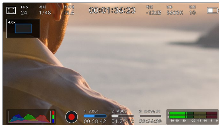
줌 인 상태에서는 LCD 터치스크린 좌측 상단에 나타나는 표시 정보를 통해 현재 확대한 부분이 이미지 속 어떤 부분에 해당하는지 확인할 수 있습니다. 메뉴 휠을 사용하거나 스크린을 손가락으로 드래그하여 영상 여기저기를 확인할 수 있습니다.
