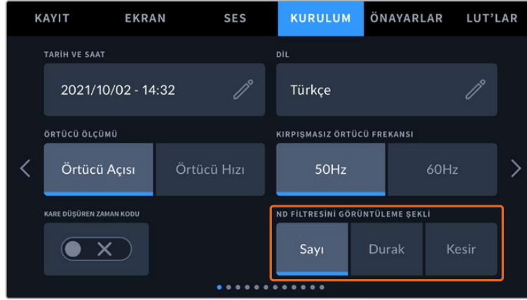
URSA Broadcast G2 kameranızda, ND filtre bilgilerinin nasıl görüntüleneceğinin kişiselleştirme seçeneklerini gösteren, kurulum menüsü.
