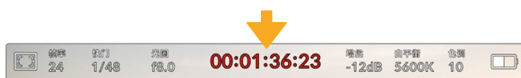
图为URSA Broadcast G2的时长显示，该数值会在记录时变成红色
