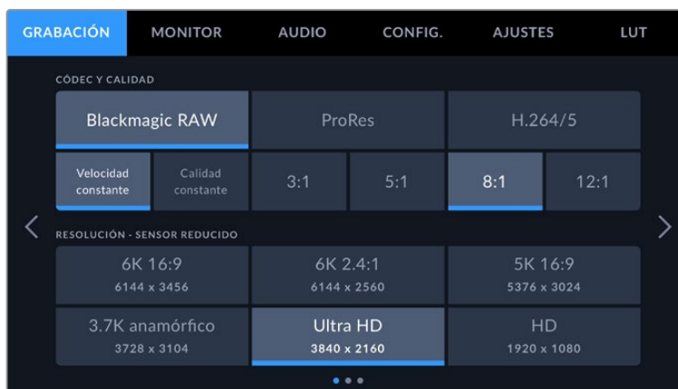
Ajustes predeterminados para el formato Blackmagic RAW en la pestaña Grabación
