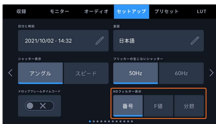
URSA Broadcast G2の「セットアップ (SETUP)」メニューのオプションで、内蔵NDフィルター情報の表示方法をカスタマイズ可能
