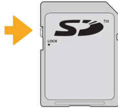
上下拨动锁定开关可锁定或解锁SD卡
