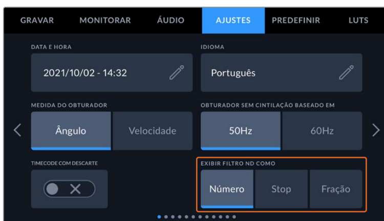
Menu de configuração da URSA Broadcast G2 com a opção de customizar como as informações do filtro ND são exibidas.
